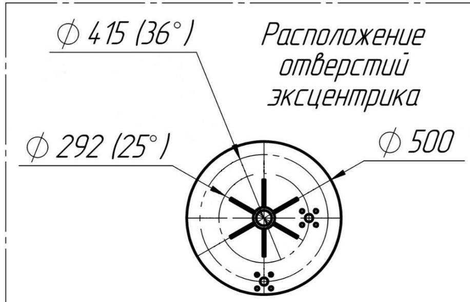
Рисунок А.3 – Расположение отверстий на круге-эксцентрике для различных углов наклона рамы установки
