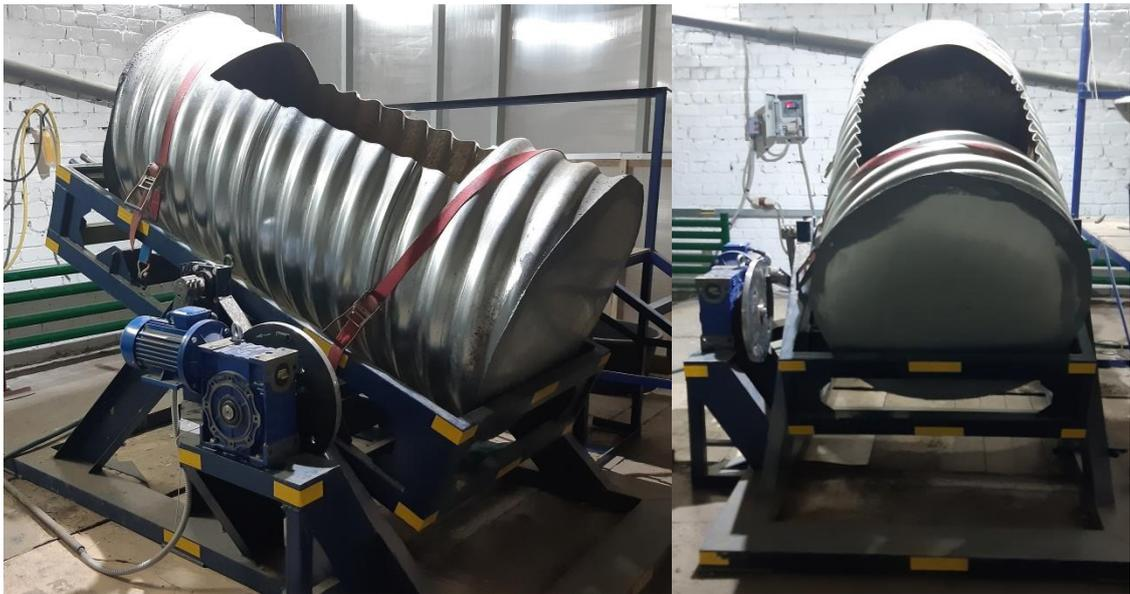
Рисунок А.1 – Пример общего вида установки для проведения испытаний СВМГТ на гидроабразивный износ
