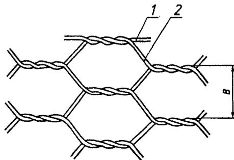
Рисунок 1. Схема шестиугольных ячеек сетки двойного кручения
