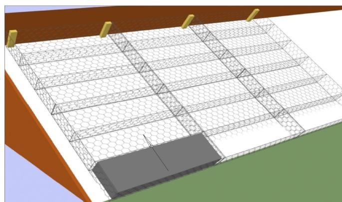
Рисунок 5.4.7 – Установка и заполнение ГСИ на склоне
