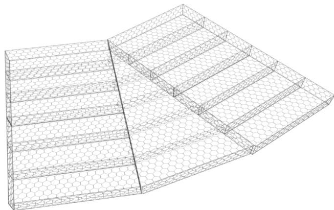
**Рисунок.3 — Укладка ГСИ в закруглении**
