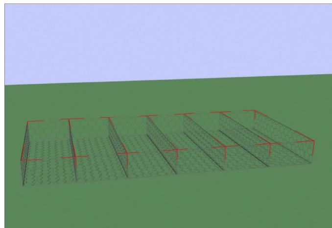
**Рисунок 5.4.3 – Общий вид собранного матрацно-тюфячного ГСИ**
