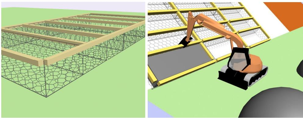
**Рисунок 5.4.8 — Вид ГСИ подготовленного для механизированного заполнения**
