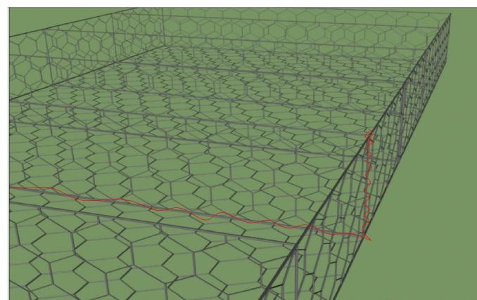
**Рисунок 5.4.4 – Привязка диафрагм ГСИ**
